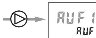
→ Die Funktion "komplettes Öffnen 1 (AUF)" blinkt. Mit
