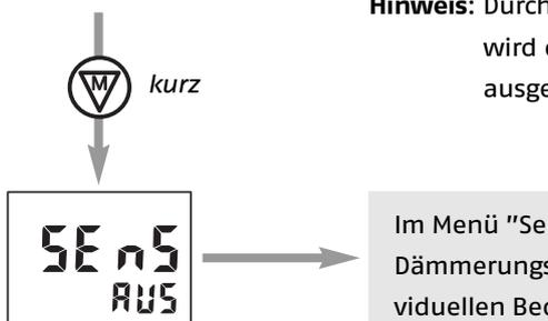
Im Menü "Sensor" können Sie die Schwellwerte für die Sonnen- bzw. die Dämmerungsautomatik (nur mit optionalem Helligkeitssensor) Ihren individuellen Bedürfnissen anpassen. Bitte beachten Sie hierzu auch die Gebrauchsanweisung, die dem Helligkeitssensor beiliegt. Im Menü wird „AUS“ angezeigt, wenn kein Sensor eingesteckt oder dieser defekt ist.
