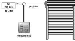
1.) Anschlussleitungen an den Klemmen des Steckrahmens anschließen (Klemmenbelegung siehe Kap. 5.2) und Steckrahmen in U.P.-Dose befesti-
