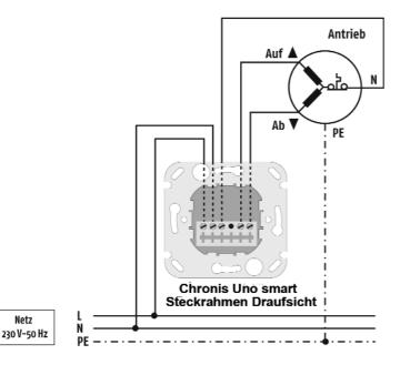
Netz Phase (L $\rightarrow$ ) Netz Nullleiter (N →) N ist intern Motor Nullleiter (N) Motor Auf (▲) Motor Ab (▼)
