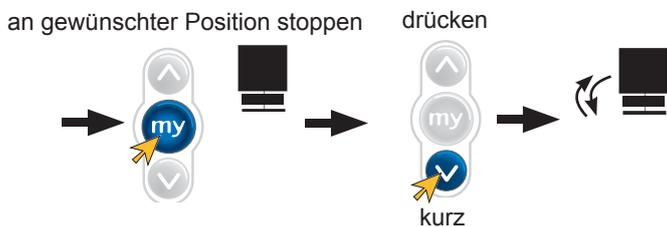
Die feste obere Endlage ist gespeichert und der Antrieb verläßt automatisch den Programmiermodus.
