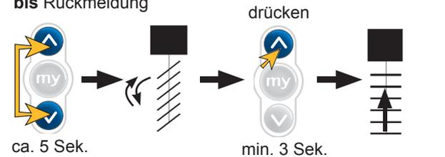
Die automatische obere Endlage ist 1 cm unterhalb des Schaltfühlers gespeichert und der Antrieb verläßt automatisch den Programmiermodus.
