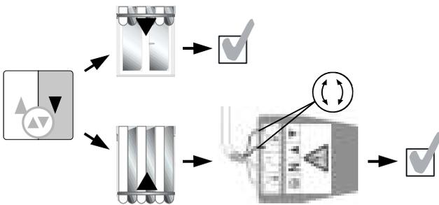
Prüfen Sie die Drehrichtung durch kurzes drücken der **AB**-Taste. Führt der Behang in die **AB-Richtung**, ist die Drehrichtung richtig eingestellt. Führt der Behang in die **AUF-Richtung**, stecken Sie das Somfy Montagekabel WT oder das Setting Tool WT aus und **ändern** Sie die Verdrahtung der Adern **schwarz** und **braun**. Prüfen Sie erneut.
