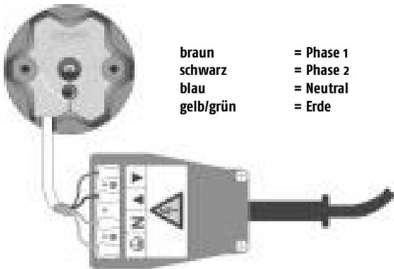
Schließen Sie Orea WT entsprechend der Klemmenbelegung an das Somfy Montagekabel WT oder an das Setting Tool WT an.
