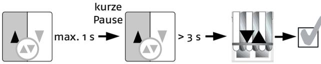
Drücken Sie **max. 1 s die AUF**-Taste. Nach einer **kurzen Pause** drücken Sie solange die **AUF**-Taste, bis der Antrieb mit einer kurzen **AUF-/AB-Bewegung** bestätigt.
