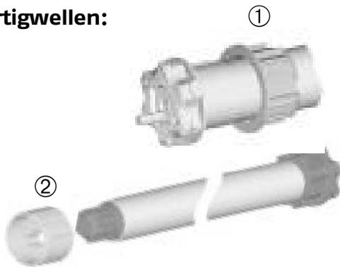
Den zur jeweiligen Antriebswelle **passenden Adapter** ① auf den Antrieb schieben. Achten Sie hierbei bitte auf den richtigen Sitz am Nocken. Anschließend den **passenden Mitnehmer** ② aufclipsen.
