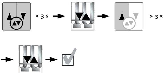
Um den Antrieb zu aktivieren, drücken Sie **gleichzeitig** die Tasten **AUF** und **AB**, bis der Antrieb mit einer kurzen **AUF-/AB-Bewegung** bestätigt. Drücken Sie nun solange die **AUF**-Taste, bis der Antrieb mit einer kurzen **AUF-/AB-Bewegung** bestätigt.
