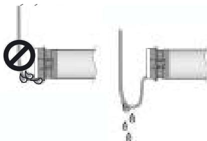
Um zu verhindern, dass Wasser in den Antrieb läuft, sollte das Anschlusskabel **in einer Schleife** nach unten verlegt werden.
