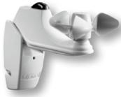
Automatische (wind-, helligkeits- und regenabhängige) Steuerung eines oder mehrerer Antriebe per Funk. **Wind-Regenautomatik:** Der Soliris Sensor RTS misst laufend die aktuelle Windgeschwindigkeit. Wird dabei der eingestellte Schwellenwert für Wind überschritten, wird die Markise zum Schutz eingefahren.
