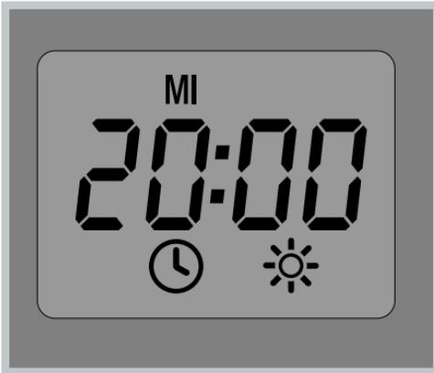
Die Beleuchtung des Gurtwicklers schaltet sich bei Bedienung für 15 Sekunden ein. Wird der Gurtwickler nicht mehr bedient geht die Beleuchtung innerhalb von fünf Sekunden langsam gedimmt wieder aus.
